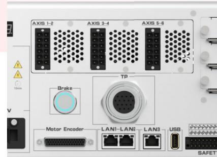
具备强大的扩展能力，支持最多32路IO扩展，可灵活连接各种外部设备，如传感器、执行器、报警装置等，满足不同生产场景下的信号交互需求。支持额外2轴扩展，可根据实际应用需求增加外部轴，适应更复杂的生产工艺，提高设备的通用性和灵活性。
