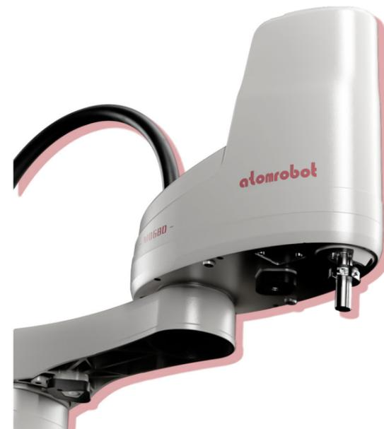
机器人臂展范围 400~610mm，大臂旋转角度可达 ±132°，小臂旋转角达到 ±154°，工作空间最大可覆盖直径 1220mm 的广扇形区域，可满足多工位长距离的搬运、分拣和装配作业。
