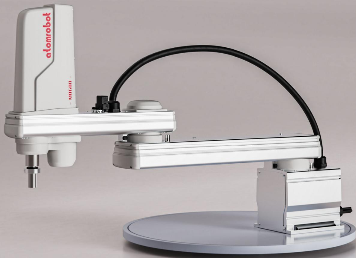
该系列工业机器人是水平多关节四自由度机器人。具有动作灵活、结构紧凑、动态性能好、运动重复性高的特点。关节采用模块化设计及组装，便于安装和维护可有效代替 20Kg 以下的轻体力劳动。
