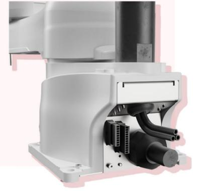
线缆与末端器件的电气路采用背部输入小臂输出的方式，便于末端装置的线/气路排布
